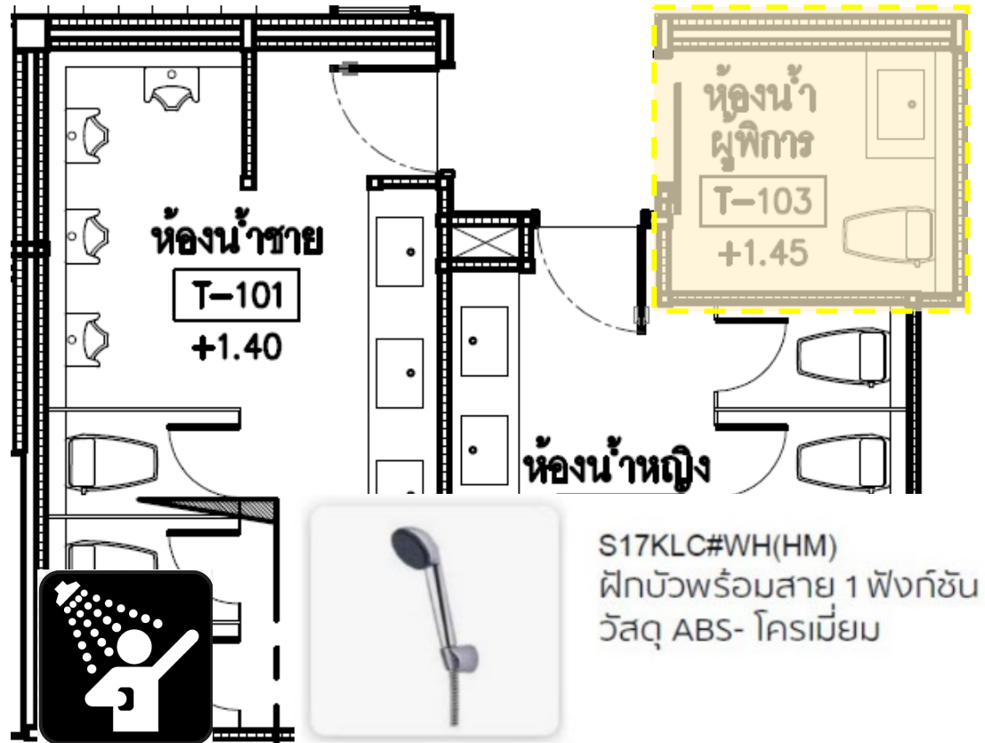
ก๊อกฝักบัวอาบน้ำ Shower (S17KLC#WH(HM)) ติดที่ห้องน้ำผู้พิการ บริเวณชั้นที่ 1
